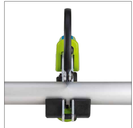
Rohre und Schläuche rechteckig schneiden
