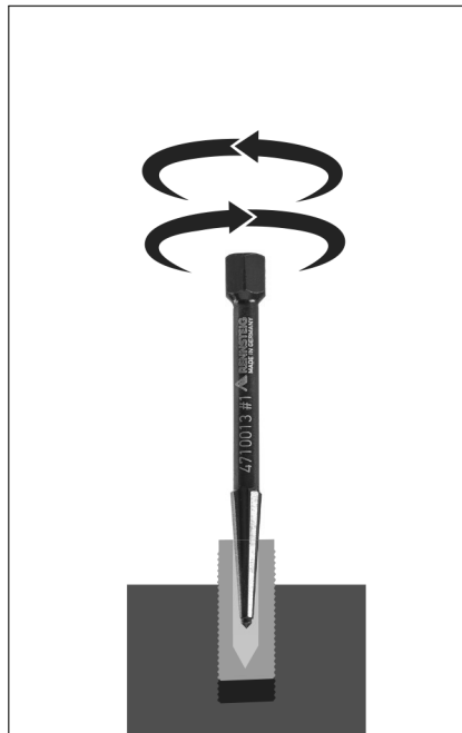
festsetzende Schraube mit passendem Werkzeug lockern und ausdrehen
