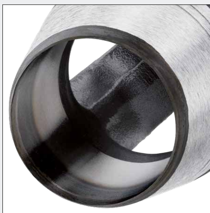
Schneide geschärft, gehärtet und angelassen
