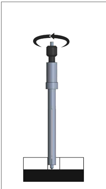
1. Zentrierkörner in passender Größe in Bohrloch einsetzen, drehen der Rändelschraube
