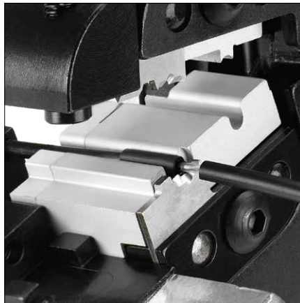
Abisolieren des Kabels sowie...
