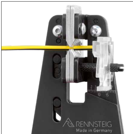
Kabel an Längenanschlag anlegen
