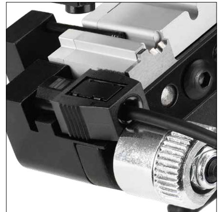
Verpressen des Steckers mit dem vorbereiteten Kabel in einem Werkzeug
